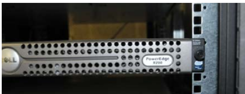
Figure 2 : serveur 1U dans une armoire
